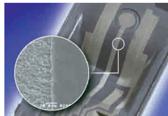
Beim LPKF-LDS-Verfahren strukturiert der Laserstrahl das Leiterbild direkt vom Rechner auf die Oberfläche des 3D-Spritzgießformteils.
