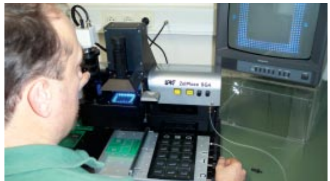
Platzierung von Bauteilen mit CCD Kamera und Monitor
