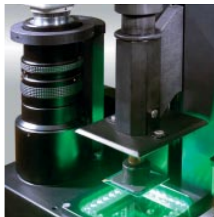
Platzierung von Bauteilen mit CCD Kamera und Monitor
