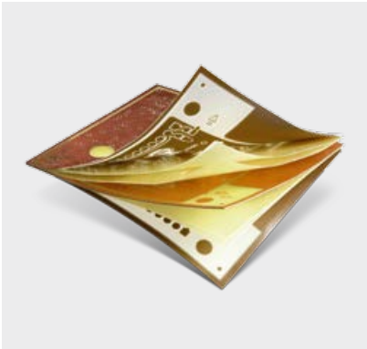
Einseitige, doppelseitige und mehrlagige Leiterplatten
