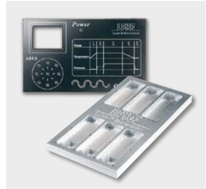
Fräsen und Gravieren von Plastik und Aluminium (2,5 D)
