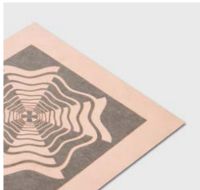
Laserstrukturieren von Keramik und PTFE
