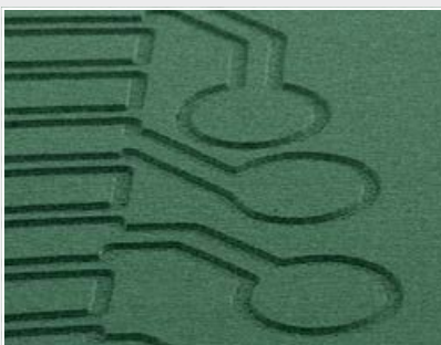
Direktbelichtung von Fotoresisten, zum Beispiel Chemisch Zinn für Feinstleiterstrukturen
